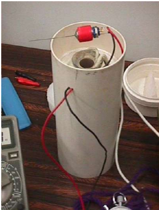
Figura 3.25 Detalhe do Calorímetro utilizado, juntamente com o termistor
