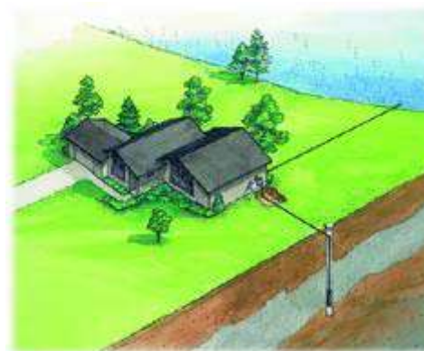
Figura B.25 Ilustração de um sistema aberto acoplado a água corrente. Em condições ideais, o sistema aberto é o mais econômico dos sistemas geotérmicos. (WAT-99)
