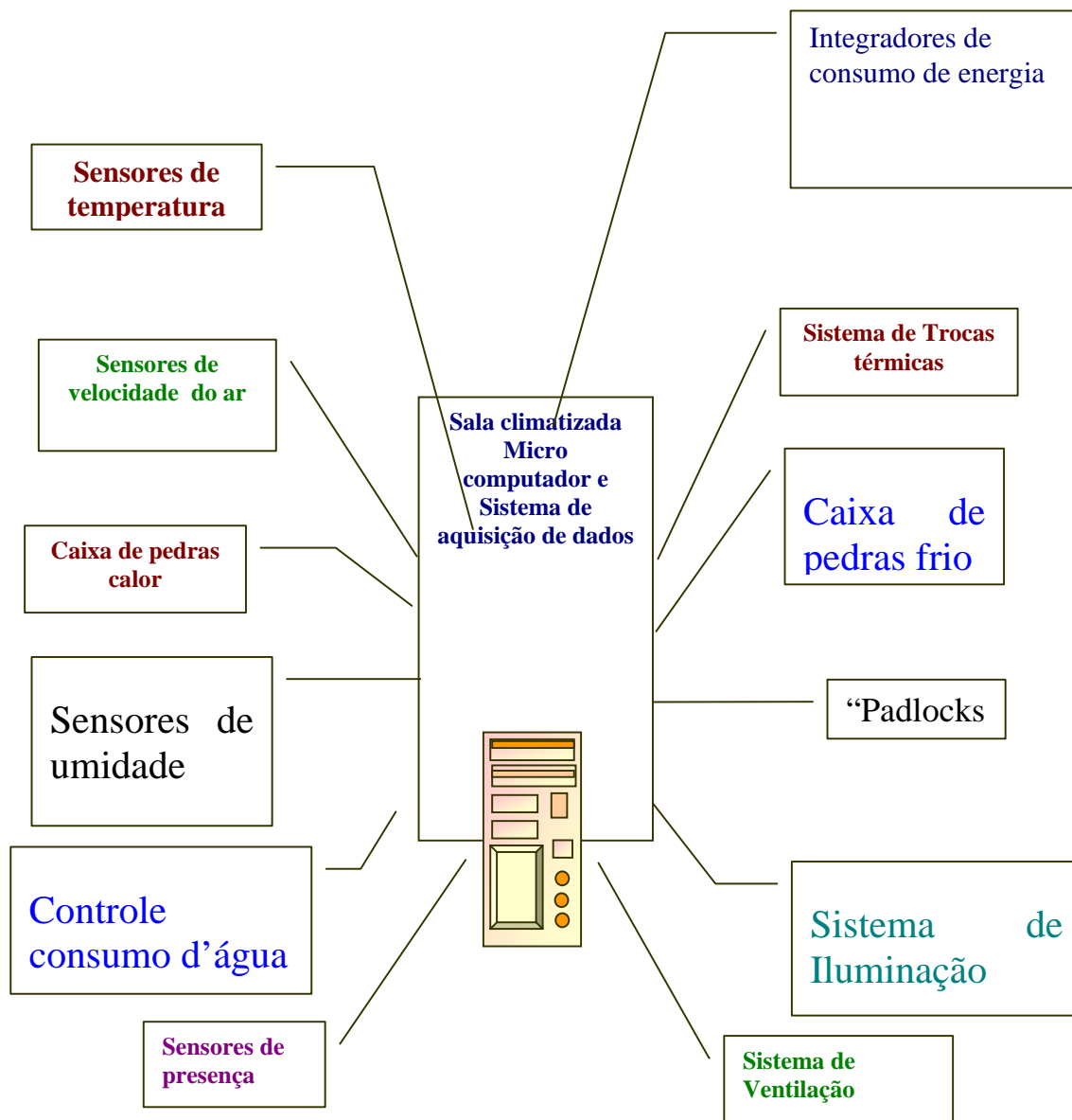
Fig. A.17 Sistema de controle dos equipamentos e sistemas de ventilação, ar condicionado, presença, consumo d'água e sensores de temperatura, umidade, radiação e integradores de energia instalados em sala climatizada
